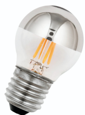
143613 LED FIL G45 Calotte Argentée E27 DIM 4W (29W) 300lm 827
